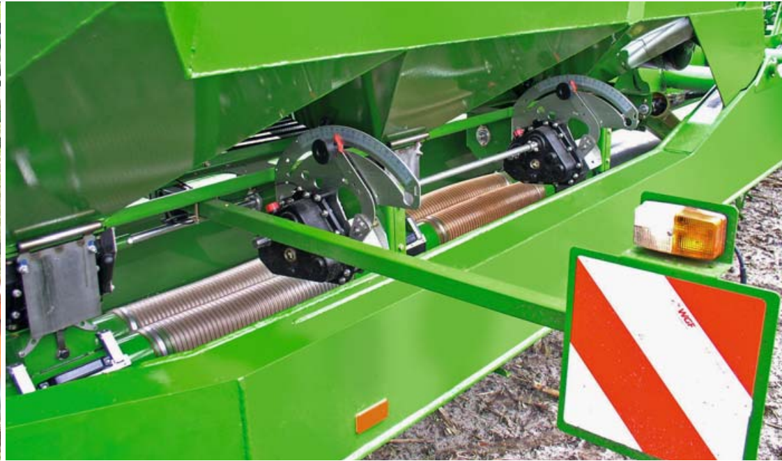
Le boîtier Vario permet des débits de 2 à 400 kg.
