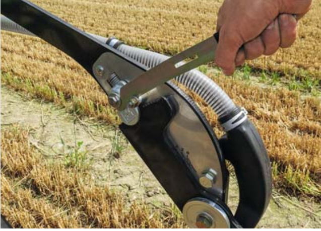
Réglage de dents de semis guidées en profondeur
